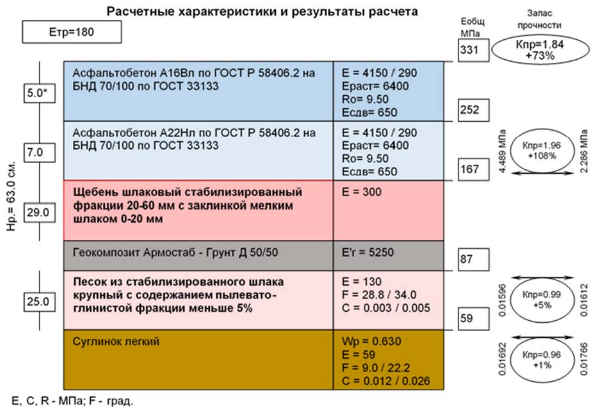
Рисунок 5.5 – Конструкция дорожной одежды для III категории с использованием щебня и песка из стабилизированного шлака
