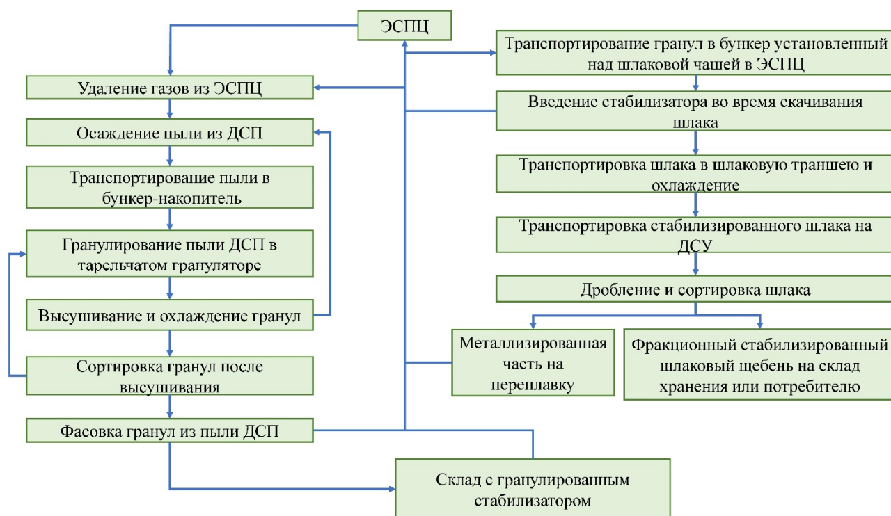
Рисунок 5.1 – Схема процесса получения стабилизированного щебня с учетом подготовки стабилизатора
