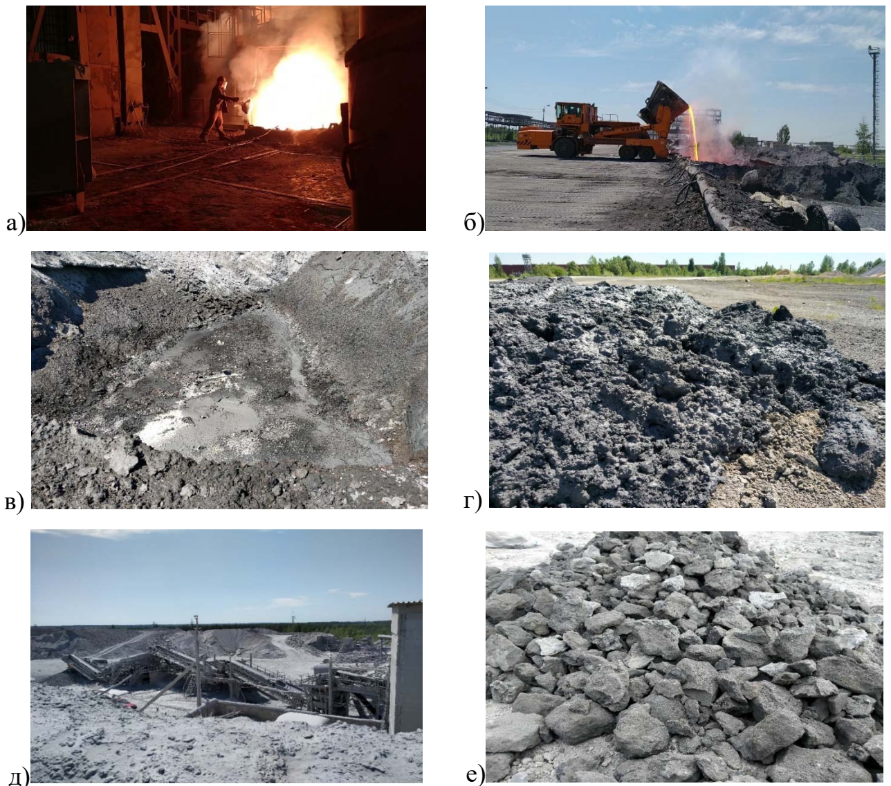
Рисунок 4.11 – Промышленная апробация технологии стабилизации в условиях цеха: а) введение стабилизатора в шлаковый ковш во время слива; б) слив стабилизированного шлака в шлаковую траншею; в) охлаждение стабилизированного шлака в шлаковой траншее; г) стабилизированный шлак после охлаждения; д) дробильно-сортировочная установка; е) стабилизированный шлак после магнитной сепарации и сортировки
