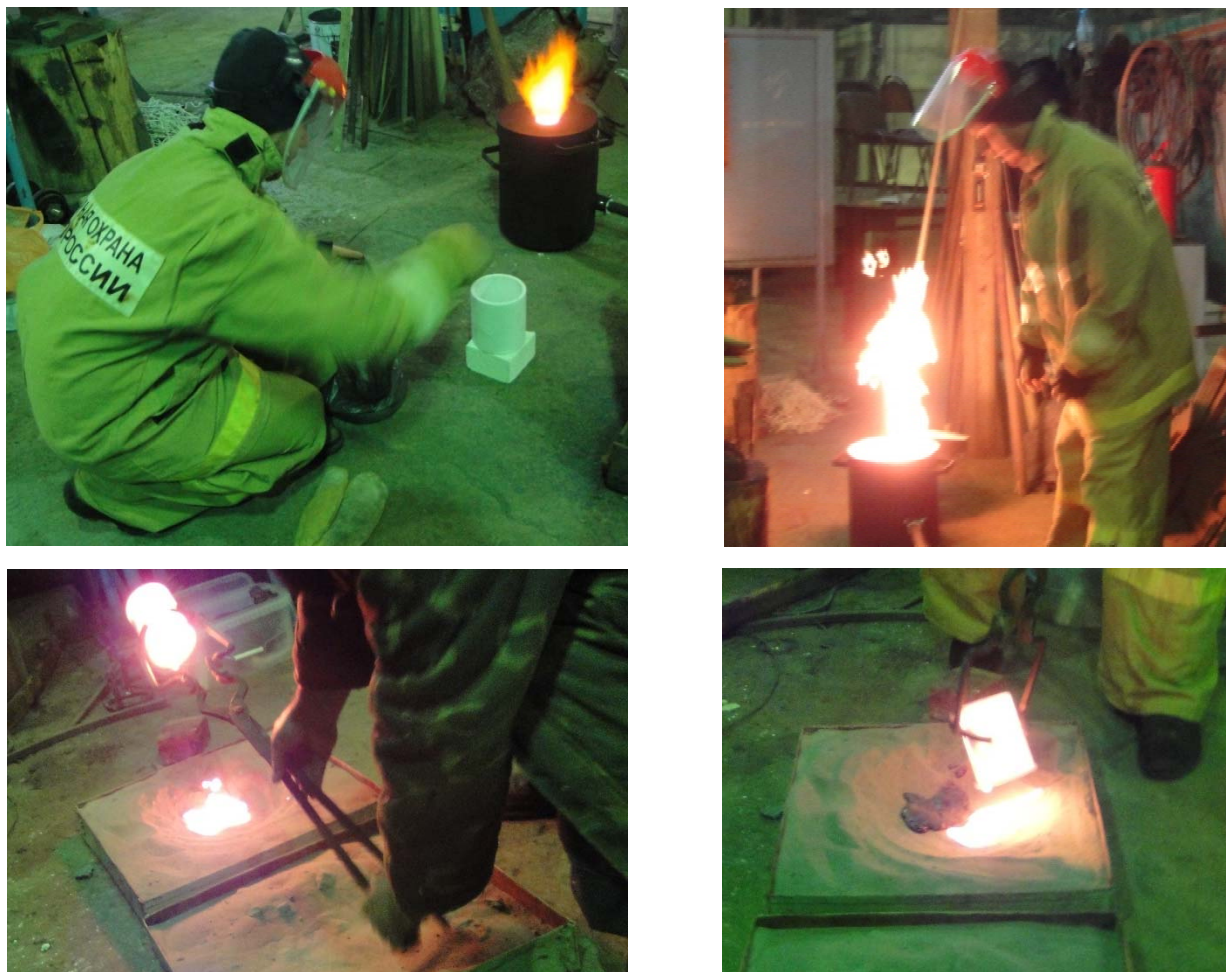
Рисунок 2.1 – Моделирование процесса стабилизации шлака в лабораторных условиях
